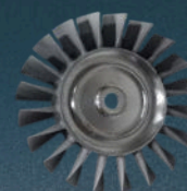
Колесо турбины (Inconel 713LC)
