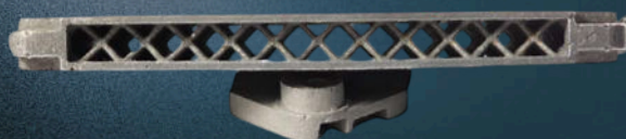
Пластина с сетчатым заполнением Сталь 12Х18Н10Т
